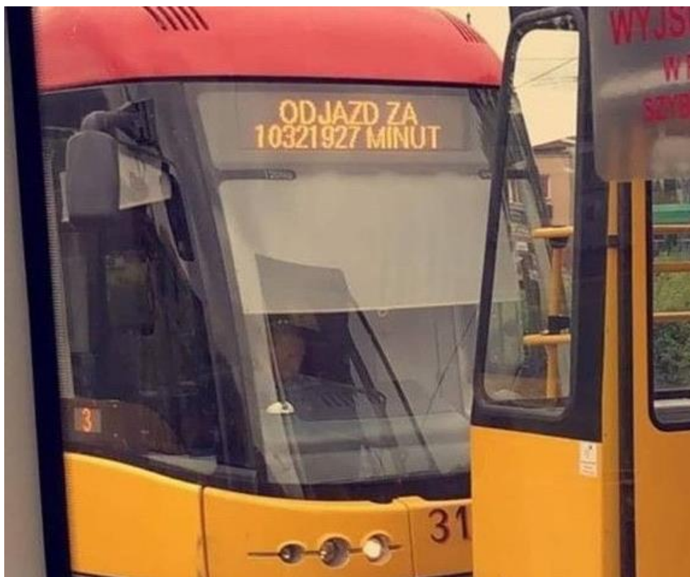
Rys. 17. (Źródło: własne) Błąd wyzerowania licznika dni tygodni GPS z 2019
