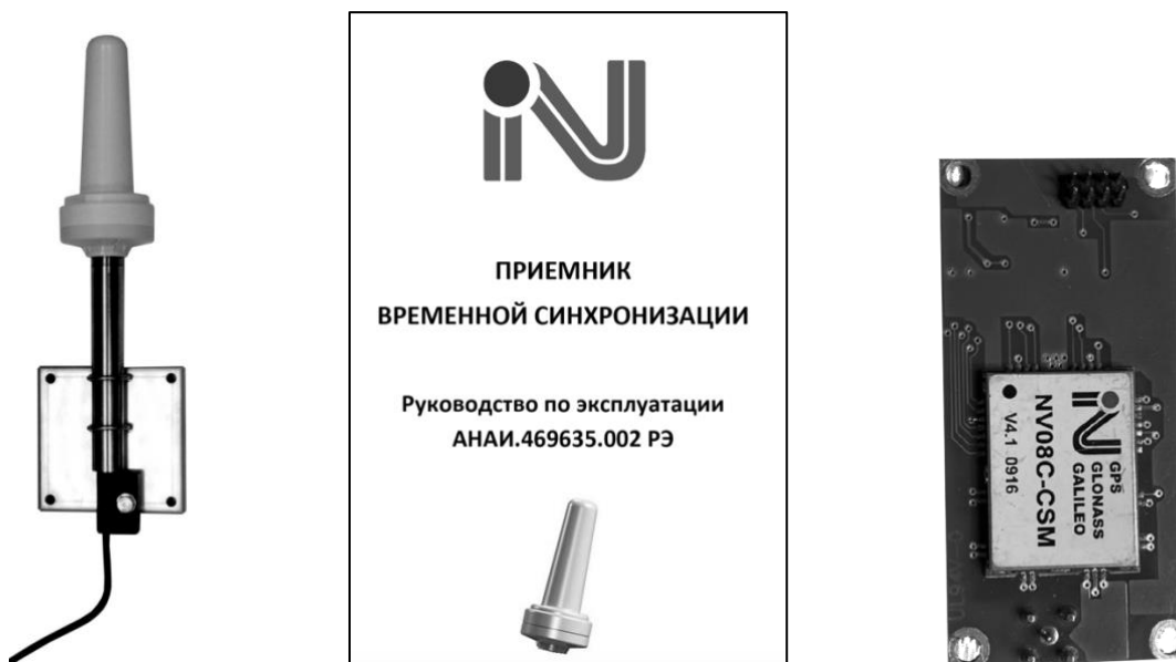
Rys. 12. Rosyjski odbiornik NVS ANAI 469635.002 oparty na systemie GLONASS jako wiodącym oraz jego wewnętrzny chipset NV08C-CSM sprzedawany komercyjnie pod szyldem szwajcarskiej firmy NVS i eksportowany globalnie
