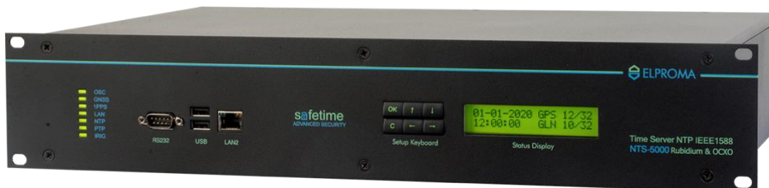
Rys. 26.c Widok panelu serwera czasu NTP/PTP model NTS-5000 używanego w systemie eCzasPL
