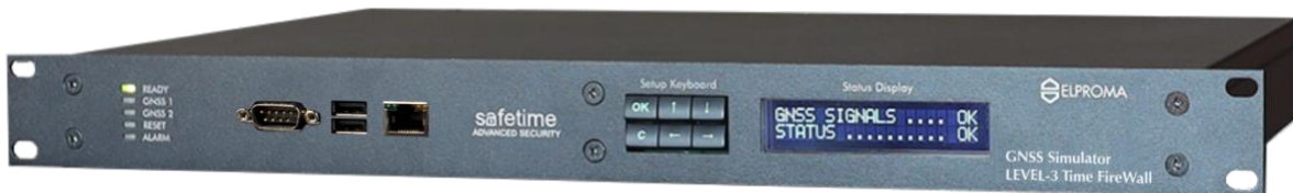
Rys. 26.b Widok panelu przedniego symulatora GNSS poziomu LEVEL-3 Elproma. To sieciowy symulator GNSS odbierający z odległych serwerów NTP/PTP GUM RP (eCzasPL) informacje i zamieniający na symulowany sygnał antenowy do serwera czasu NTS-5000
