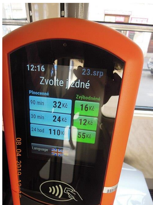
Rys. 18. (Źródło: własne) Błąd wyzerowania licznika dni tygodni GPS z 2019 - skok o 19.7 lat. (górny rysunek) w żyroskopie samolotów Boeing; dolny rysunek w systemach fiskalnych w Pradze.
