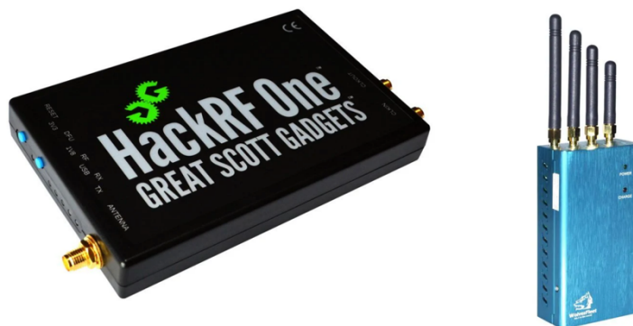
Rys. 11. Mobilny programowalny spoofer i jammer GPS Źródło: własne
