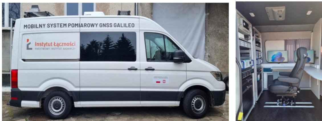
Rys. 35. Mobilne stanowisko pomiarowe do badania jakości i zakłócania sygnałów GNSS
