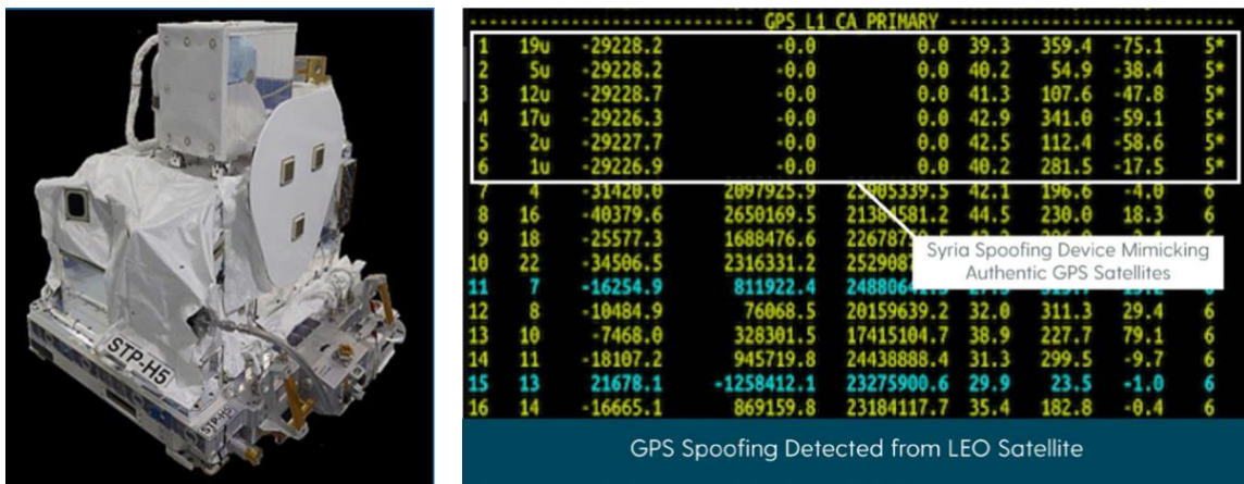
Rys. 18. Użyty sensor STP-H5, zainstalowany na stacji ISS (orbita 400km nad Ziemią) wyposażony w odbiornik GPS służący do badań jonosfery. Zdekodowane dane wykazały w polach LNAV wartość 0, tzw. „coded jamming”
