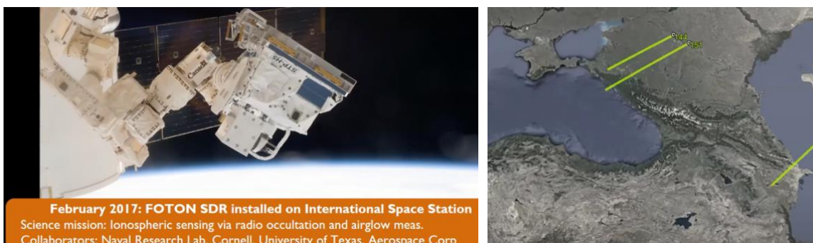
Rys. 19. Rejestracja zakłócanego w rejonie Morza Czarnego sygnału GPS wykonana w roku 2017 z poziomu stacji kosmicznej ISS za pomocą sensora STP-H5
