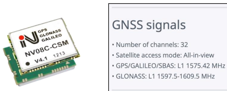
Rys. 13. Układ odbiornika GNSS „szwajcarskiej” (rosyjskiej) firmy NVS sprzedawany jest globalnie również przez amerykańskich wiodących dystrybutorów podzespołów elektronicznych Źródło: Internet www.nvs-gnss.com
