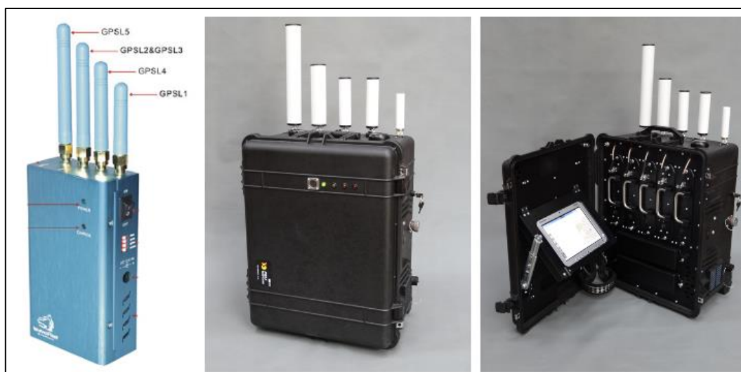
Rys. 34. Mobilny jammer GPS produkcji chińskiej (na lewo). Polskiej produkcji PIAP iTTi/Łukasiewicz profesjonalny programowalny jammer (prawa część), model ZKR-1 o mocy 150W i paśmie 25-5800 MHz, generujący ciągły i responsywny Źródło: iTTi / Łukasiewicz
