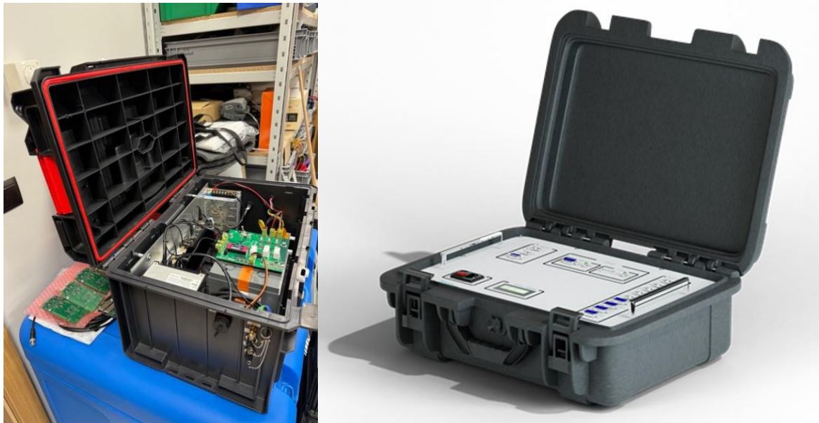
Rys. 41. Polski przenośny „defibrylator” UTC ELPROMA, po prawej izraelski „Time Loader”. Wielkość urządzenia determinuje czas podtrzymania UTC i zależy od pojemności akumulatorów. Źródło: własne
